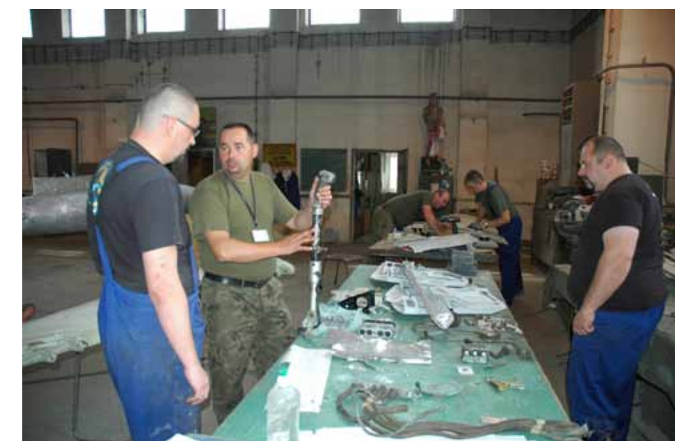
MiG-19 został rozebrany na części pierwsze i poddawany konserwacji
