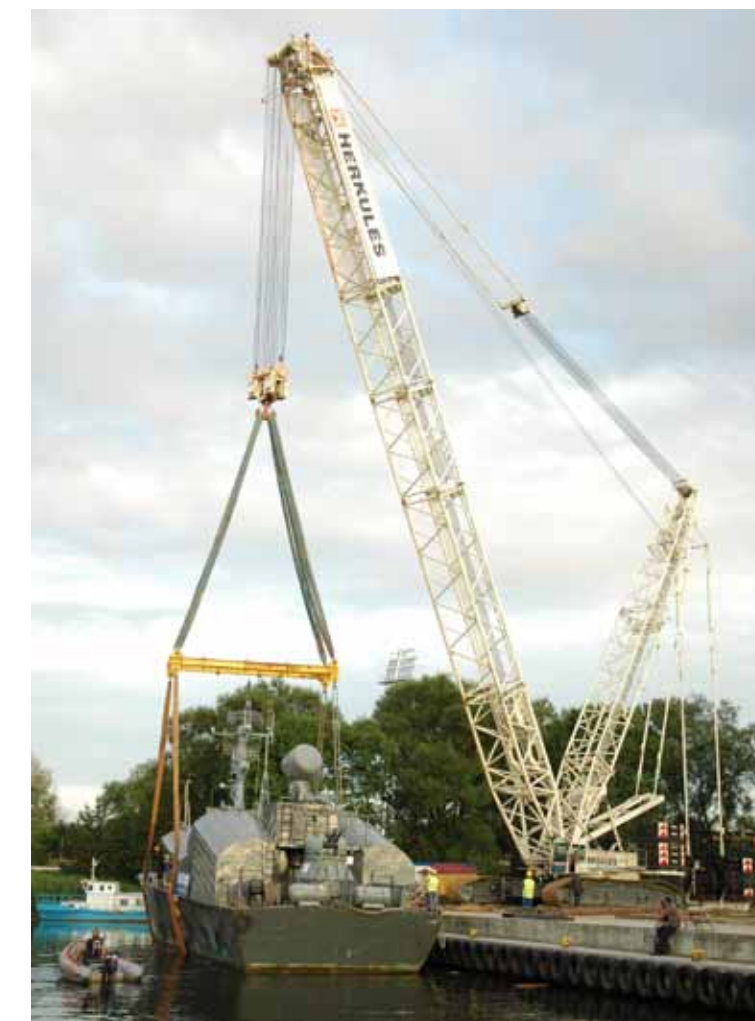
Dźwig o max nośności 700 ton za chwilę uniesie ORP Władysławowo...
